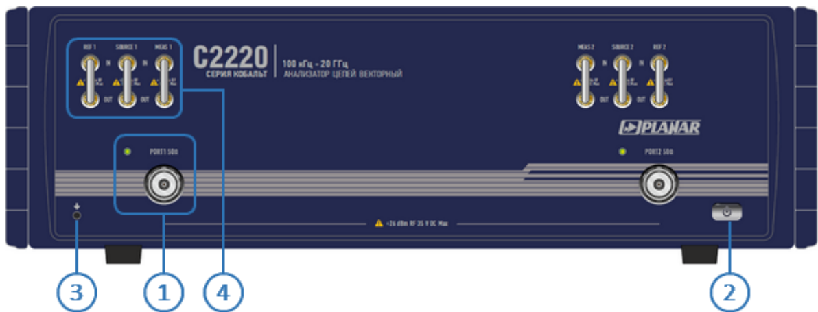
Рисунок 30 – Передняя панель C2220
