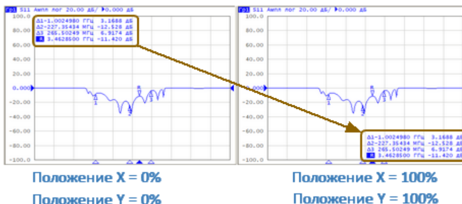
Рисунок 175 – Расположение индикации данных маркеров на экране
