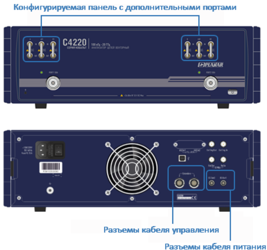
Рисунок 212 – Расположение дополнительных разъемов анализатора C4220
