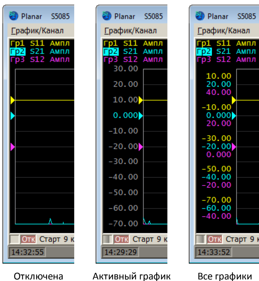
Рисунок 248 – Оцифровка вертикальной оси
