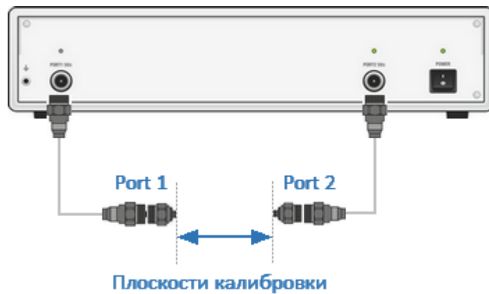
Рисунок 120 – Пример плоскостей калибровки
