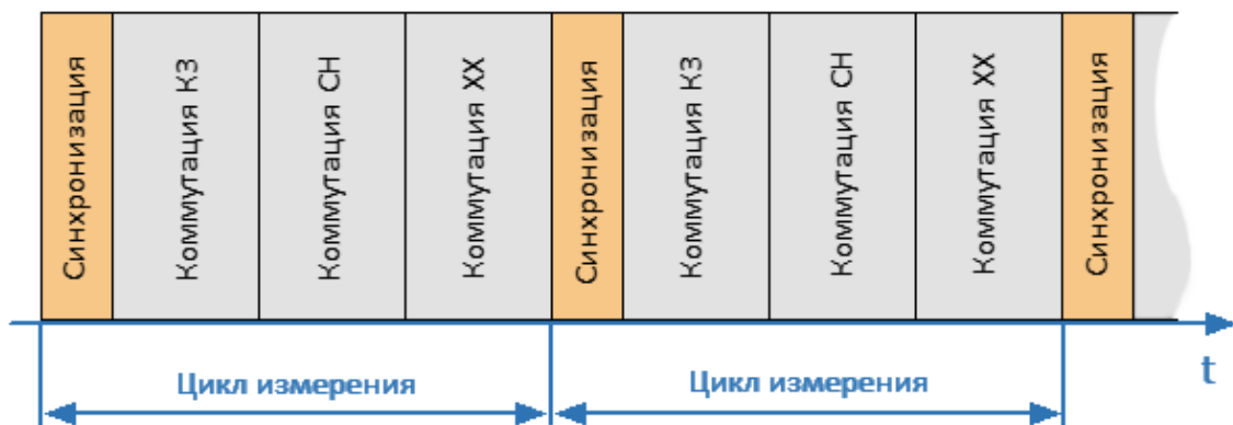
Рисунок 160 – Временная диаграмма рабочего цикла модуля
